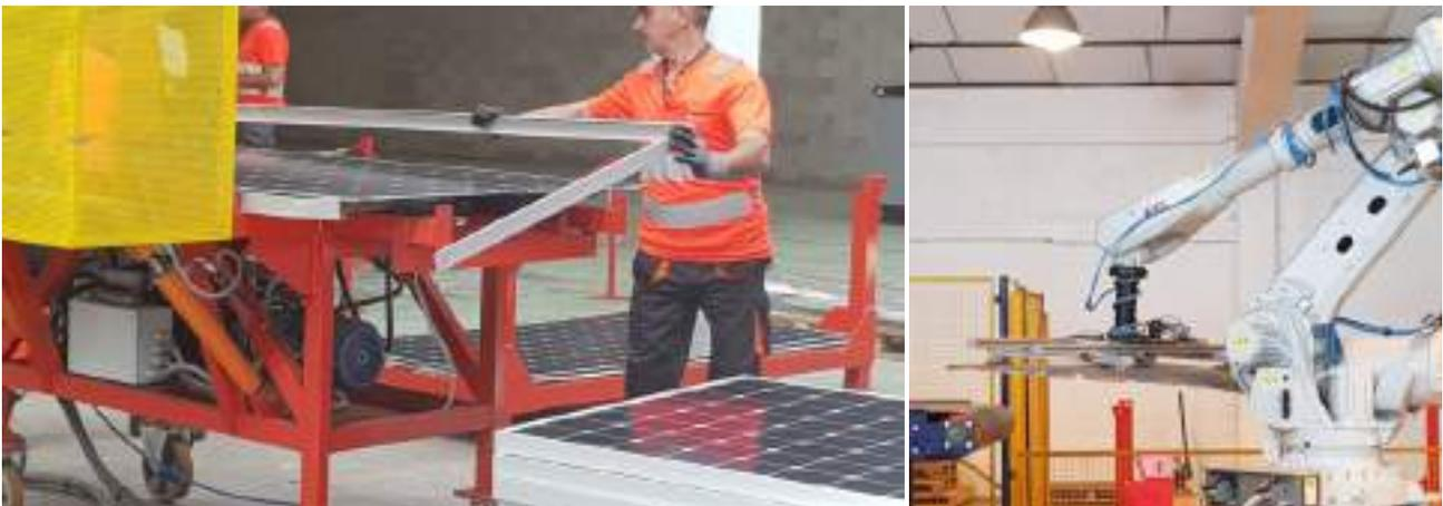
*Décadrage des modules et hargement du modules laminés avant découpage, broyage et séparation des éléments*
