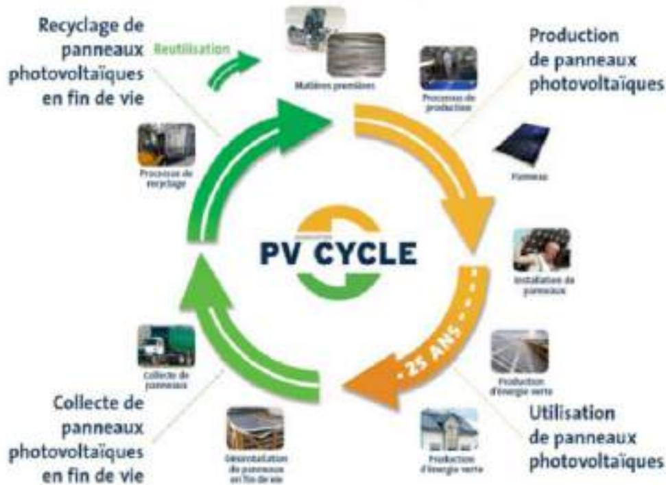
*Schéma du cycle de vie des panneaux photovoltaïques en silicium cristallin*
