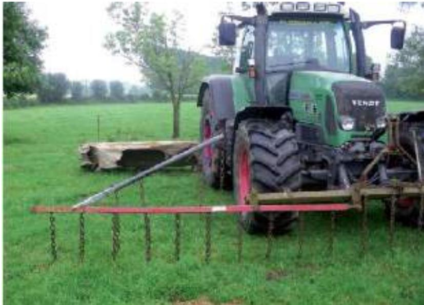
*Barre d'effarouchement implantée sur un engin mécanique - Source ETEN*
